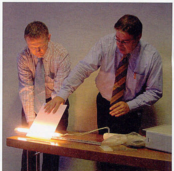
Infrarot-Wärme hilft beim Biegen von Kunststoff.
