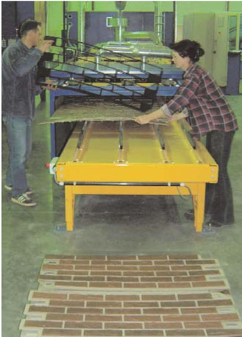
Die Beschichtung der spritzgussgeformten Kunststoffteile bildet die Naturstein- und Klinkeroptik perfekt nach
