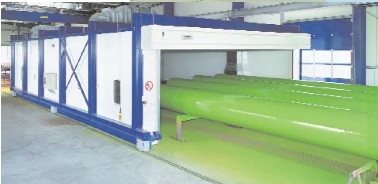
Der Trockner fährt über soeben beschichtete Rohre
